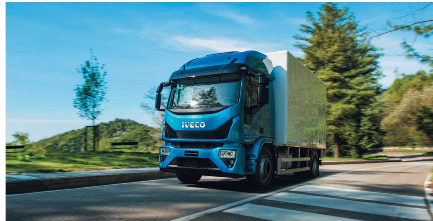
EUROCARGO: UN'ALTRA TAPPA NEL NOSTRO PERCORSO DI MIGLIORAMENTO DELL'EFFICIENZA. I motori Tector 5 e 7 adottano un olio motore a bassa viscosità che riduce gli attriti, aumenta l'efficienza e allunga gli intervalli di manutenzione.
